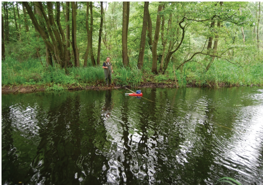
Ryc. 4. Pomiar natężenia przepływu i rozkładu prędkości w przekroju nr 3 wykonany za pomocą profilomierza dopplerowskiego (ADCP) StreamPro
